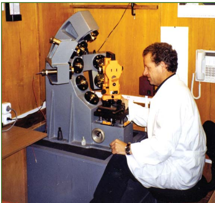
С.А. Куликов выполняет поверку теодолита на коллиматорном стенде
