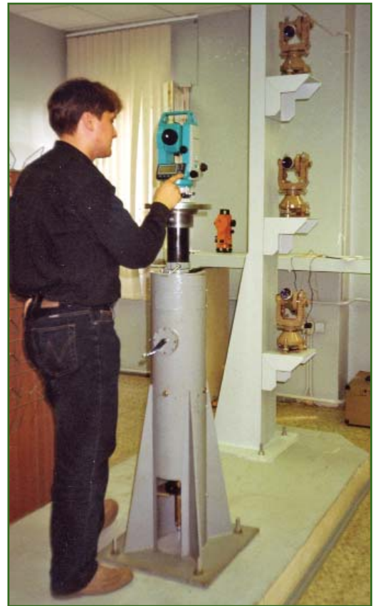
Новое помещение Сервисного центра ГСИ. Подъемное устройство с установленным на нем электронным тахеометром для проверки
