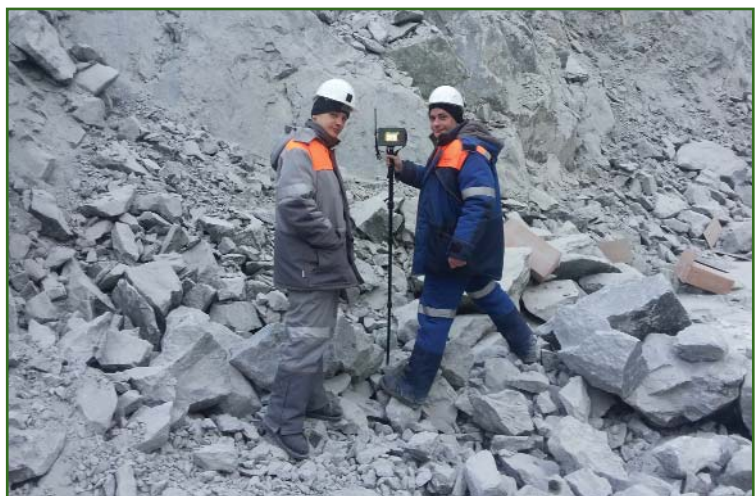
Рис. 2 Специалисты компании «Ресурсы Албазино» определяют объем руды на одном из карьеров месторождения Албазино
