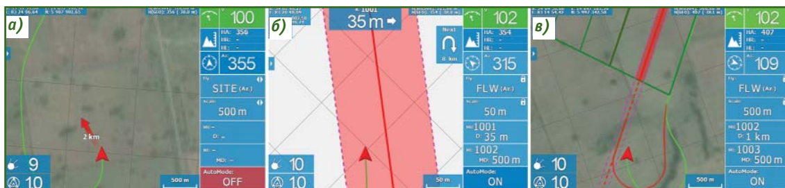
Рис. 4 Рабочее окно программы RouteNav при различных режимах пилотирования: а) перелет к участку работ; б) выдерживание маршрута; в) переход с маршрута на маршрут
